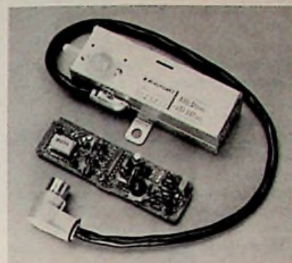
Bild 6. ASU-Schaltung zum Nachrüsten durch Anstecken
